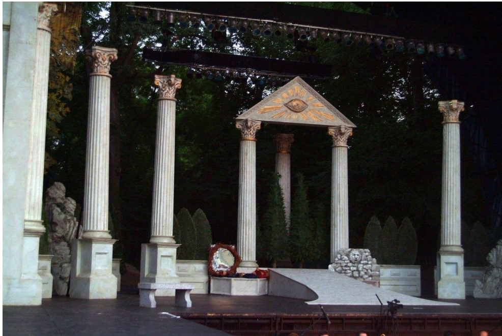
Produktion hat ca. 3,7 m hohe Säulen stehen auf 1m hohen Podest (siehe Aufbauplan). Auf den mittleren beiden Säulen ist ein dreieckiges Dachelement (Tympanon) von 1,70m dieses wiegt 80kg und muss in den Traversen fixiert werden.
