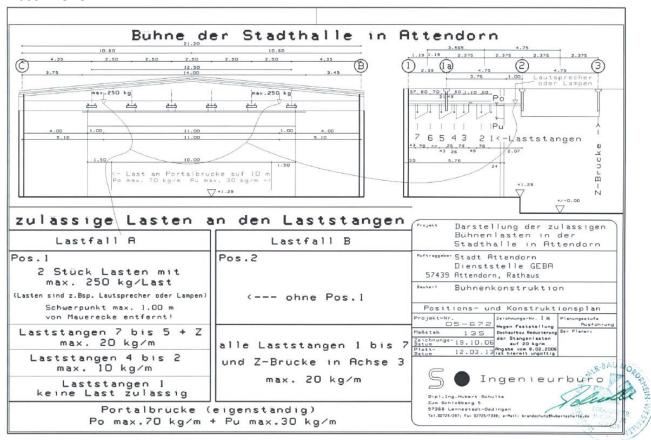
07 x Prospektzüge / Ø 50 mm / L: 14 m / mit max. WLL 250 kg pro Zug Handbetrieb an der linken Bühnenseite (Stage right)
